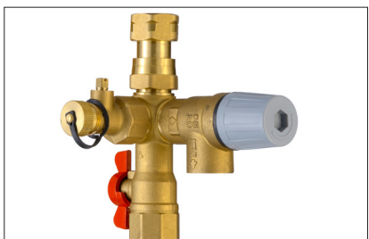
31. Sikkerhedsventil for brugsvandsopvarmningen med åbningstryk på 10 bar. Tages fra beholder og monteres på koldt vand uden for unit.
